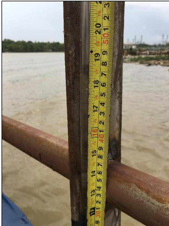
Figura 21. Mangueira e trena fixados no bordo da embarcação para medir o desnível (método do tubo “U”). Fonte: Autor (2018).
