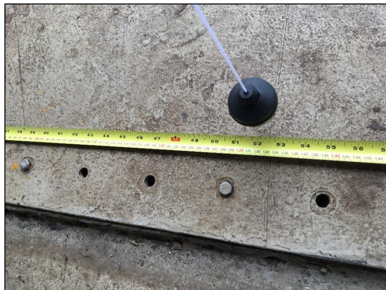
Figura 20. Prumo do pêndulo e a trena fixada no convés da embarcação durante o teste de inclinação. Fonte: Autor (2018).
