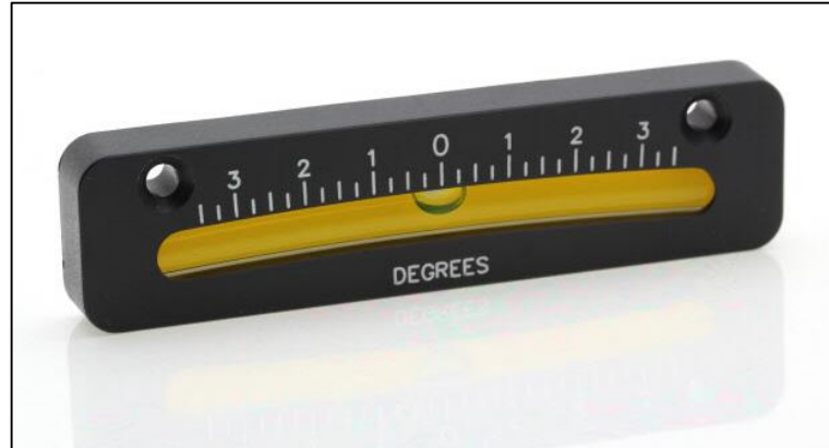
Figura 13. Inclinômetro manual de nível, utilizando bolha de ar. Fonte: Level Developments (2017).
