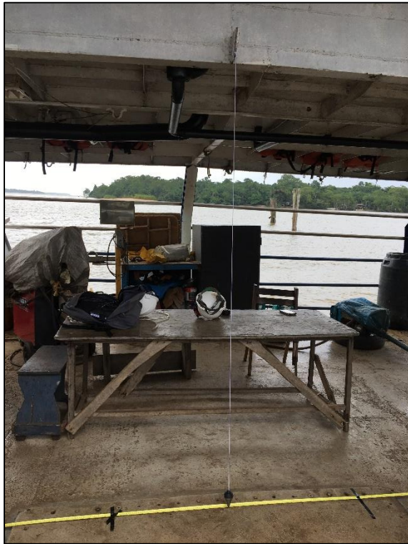
Figura 19. Pêndulo fixado na embarcação para o teste de inclinação. Fonte: Autor (2018).
