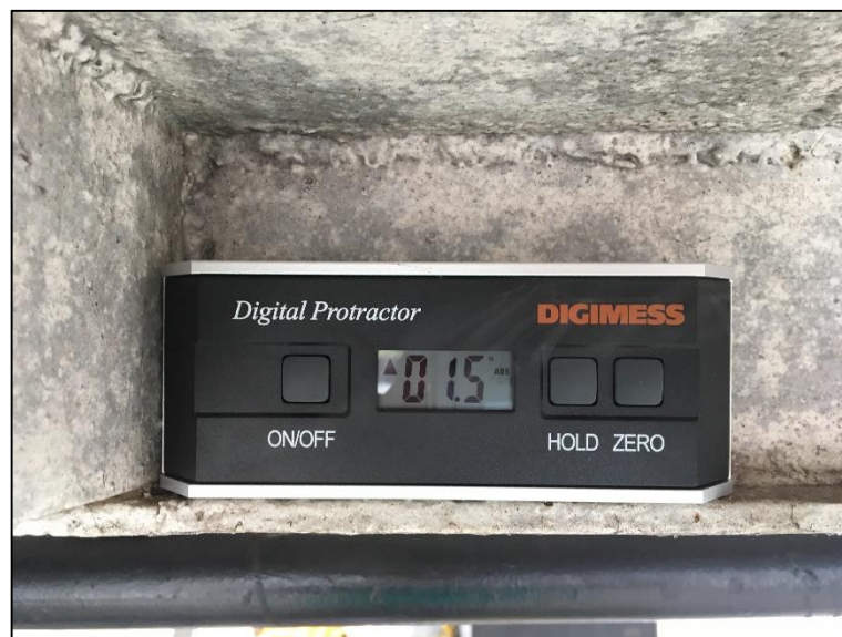
Figura 22. Inclinômetro digital posicionado na embarcação medindo o ângulo de inclinação, durante o teste. Fonte: Autor (2018).
